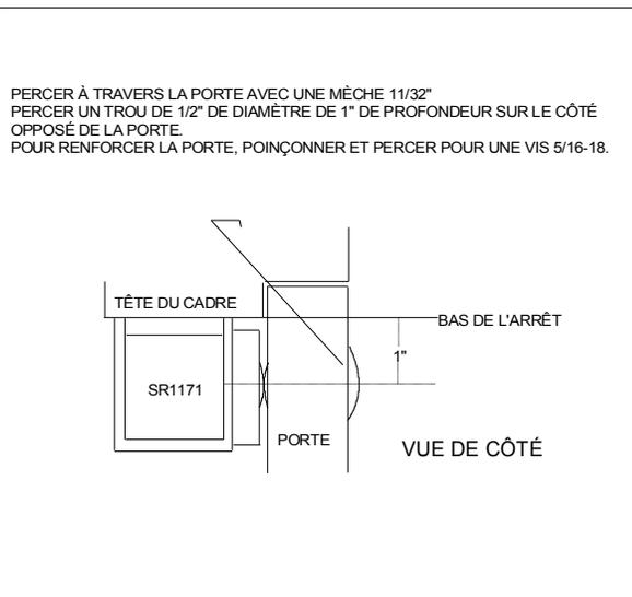
\* NOTE 1 : POINÇONNER ET PERCER LE CADRE POUR DES VIS 1/4-20 ( 2 EMBLEMES)
